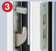
So fühlen Sie sich sicher zu Hause: 2 konische Schwenkriegel rasten mit 2 zusätzlichen Sicherungsbolzen sowie 1 Schlossriegel in die Schließbleche der Zarge ein und ziehen die Tür fest an. Auf der Bandseite machen 3 weitere Sicherungsbolzen ein Aushebeln der Tür praktisch unmöglich. Mit Softlockfalle für leichtes Schließen der Tür.
